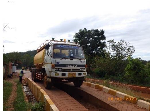
รูปที่ 2-15 จุดล้างน้ำหนักรถบรรทุกก่อนออกภายนอกพื้นที่โครงการฯ
